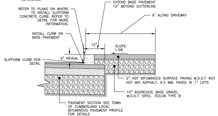
INTERNAL BITUMINOUS SIDEWALK ALONG DRIVEWAY DETAIL
